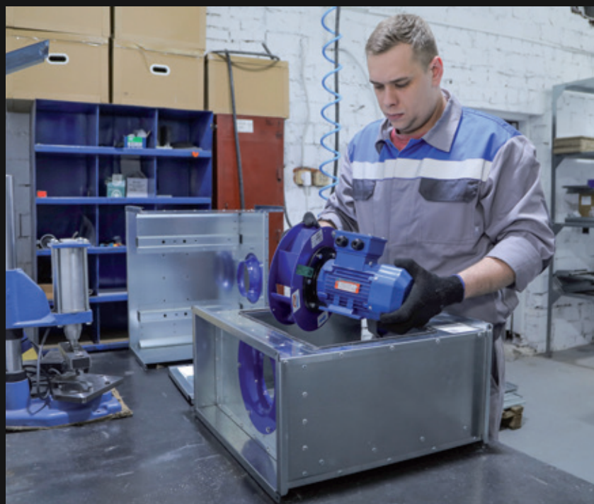
Производство элементов наборной вентиляции
