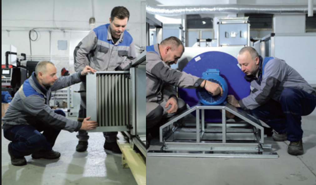
Производство каркасно-панельных вентиляционных установок
